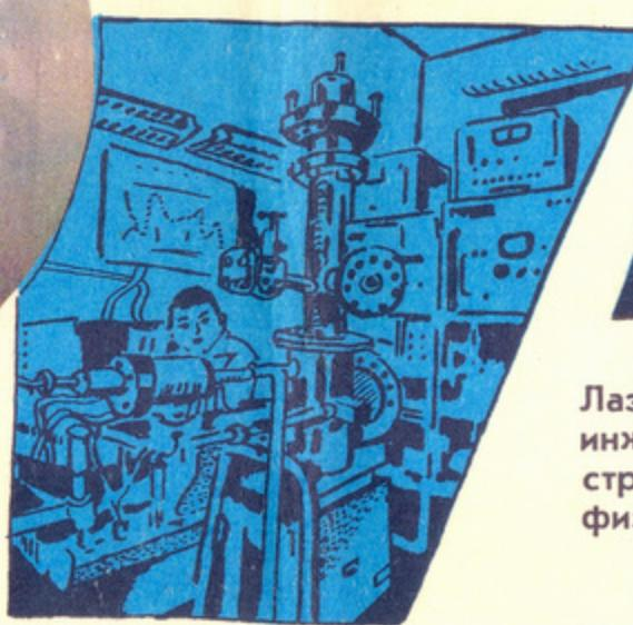
Разработанная на кафедре «Физические методы и приборы контроля» установка «космического» вакуума позволяет убрать кривое зеркало адсорбционных пленок и загрязнений и открывает первозданную картину природного кристалла.
