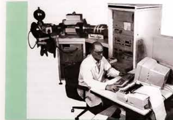
Магнитометр POS-1 в составе меры поля Institut Royal Meteorologique Centre de Physique du Globe (Бельгия), 2001 г.
